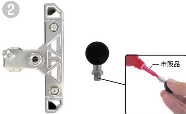
ねじロック剤が残っている場合、除去した後ボールへねじロック剤(中強度以上)適量を塗布します
