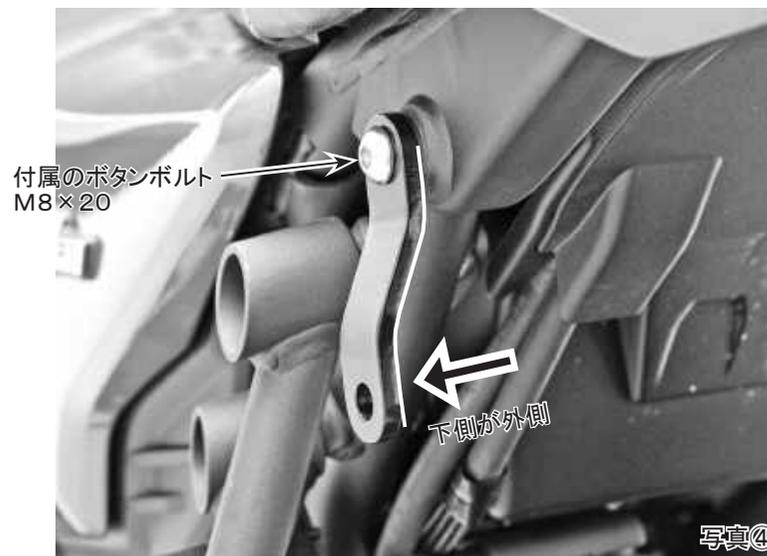
5. 前項3、4で仮止めしたステーとサイドバックサポートを付属のボタンボルトM8×20、ナットで仮止めしたのち、各部のクリアランス、位置を調整しながら、規定トルクで締め付けて完成です。(写真⑤)
