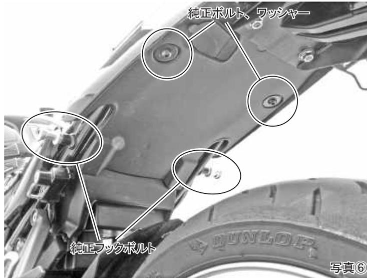
2. 前項1で取り外した純正ワッシャーと付属のリアステー、カラー、ボルトM8×50、ワッシャーを、写真のようにセットします。(写真⑦)
