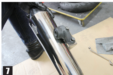
⑦テーパードコーンマフラーに純正マフラーブラケットを移設する ⑧エキパイに差し込む ⑨タンデムステップのボルトをセットする
