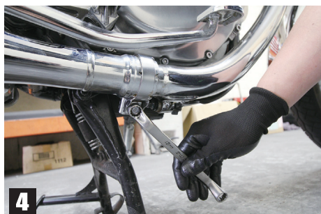
④純正マフラーのクランプを緩める ⑤タンデムステップのボルトを外す ⑥純正マフラーブラケットを取り外す
