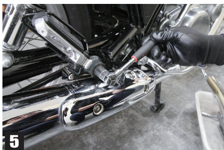
④純正マフラーのクランプを緩める ⑤タンデムステップのボルトを外す ⑥純正マフラーブラケットを取り外す
