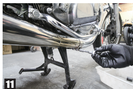
⑩ブラケットのナットを本締めする ⑪マフラーバンドを締める ⑫各部増し締めし完成です
