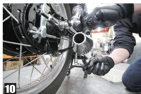
⑩ブラケットのナットを本締めする ⑪マフラーバンドを締める ⑫各部増し締めし完成です
