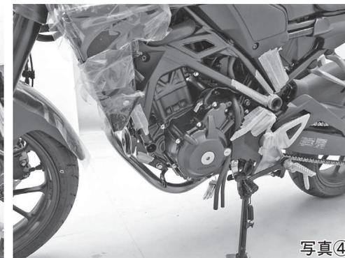
3. クロスパイプキャップをプラスチックヘラなどでフレームを傷つけないように取り外します。（写真⑤）
