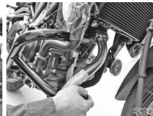
10. エキゾーストパイプを押しながら後ろ側ステーを所定の位置まで移動します。(写真⑭)
