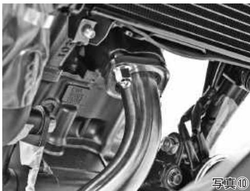
8. エキゾーストパイプマウントナットを取り外し、エキゾーストパイプマウントボルトを取り外します。(写真⑪)
