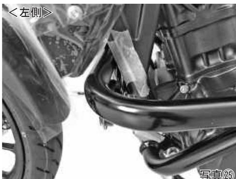
16. 各部の調整が終わったらエンジンハンガープレートボルトとエンジンハンガーナット、袋ナットを規定トルクで締め付けます。ハンドルを左右に切って何も干渉しないことを確認して、再度各ボルトナットの締め付けを確認し、前項8で取り外したエキゾーストパイプマウントボルト、ナットを取り付け、前項7で緩めたエキゾーストパイプジョイントナットを規定トルクで締め付けます。
