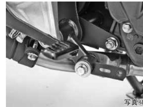
9. サイドスタンドの状態で作業する場合は右側エンジンエンジンガードを先に仮止めすると作業しやすくなります。まず、エンジンガードをラジエーターホースとフレームの間に通します。(写真⑫)
