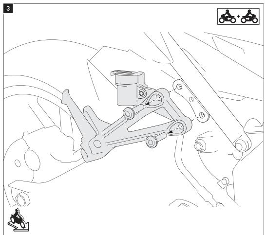
Lösen Sie **beidseitig** die original Schrauben der Soziusfußrastenhalter und entfernen Sie diese vom Fahrzeug.
