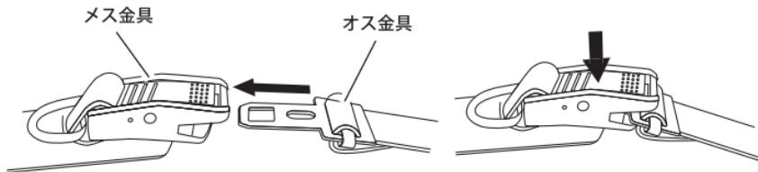
オス金具をメス金具とかみ合うまでしっかりと差し込んでください。外す時は、バックルの「PRESS」部分を押してロックを解除してください。
