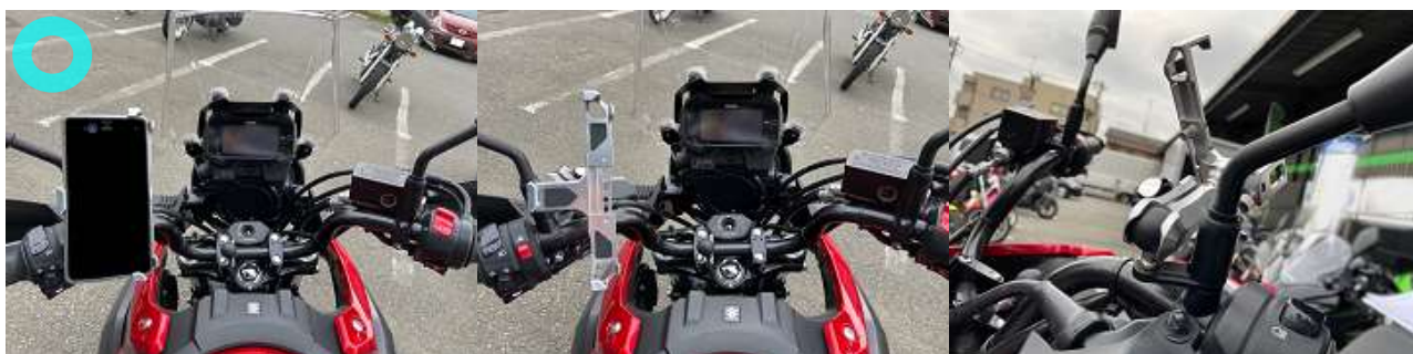
☆メーターの視認性良好・車体干渉無い取付状態 (使用マウント:A-45/B-6/C-37)
