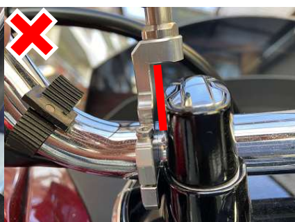
✕取付部隙間あり (C-27)
