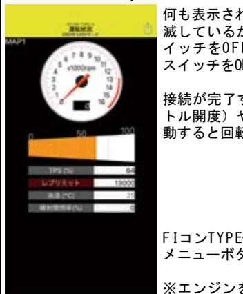
何も表示されない場合、車両のPGM-FI警告灯が点滅しているか確認し、していない場合はメインスイッチをOFFにしスロットルを全開にしてメインスイッチをONにします。
