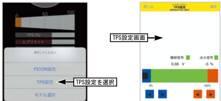
画面のスロットルポジショングラフを見ながらアクセルを全閉~全開してみます。スロット開閉に連動し、ブラックのラインが左右に動きます。それぞれの値を0%位置と100%位置で一致する様にレベル調整スイッチで調整して下さい。最後に必ず右上の“保存”を押して下さい。保存しないと反映されません。
