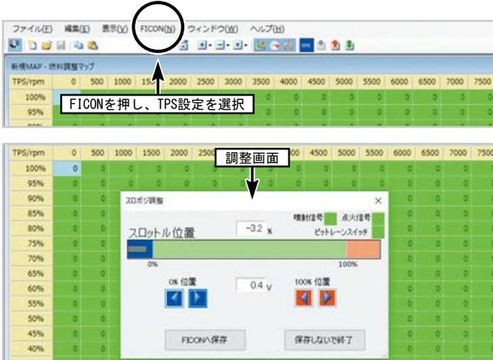
画面のスロットルポジショングラフを見ながらアクセルを全閉~全開してみます。スロット開閉に連動し、グレーのラインが左右に動きます。それぞれの値を0%位置と100%位置で一致する様にレベル調整スイッチで調整して下さい。最後に必ず“FICONへ保存” ボタンを押して下さい。保存しないと反映されません。
