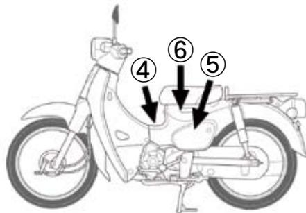
・①フロントカバー、②メインスイッチカバー、③レッグシールド、④センタカバー、⑤サイドカバーを外してから、⑥ボディカバーを取り外します。
