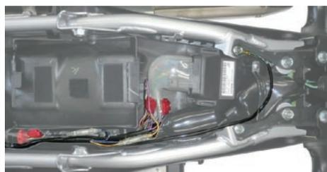
⑤ハーネス COMP. のギボシ端子を、車体側ハーネスに取り付けたサブコード及びギボシ端子と接続します。
