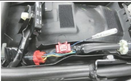
②純正 ECU に接続されているメインハーネスのカバーを開き、キット付属のサブコード2本(青/黄コード)(黄コード)を、メインハーネスの同色コードにそれぞれエレクトロタップで接続します。
