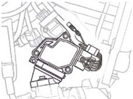
純正スロットルボディ部 5P カブラのビニールチューブを少し切り開き、黄色コードにサブコード-2(黄)をエレクトロタップで接続します。
