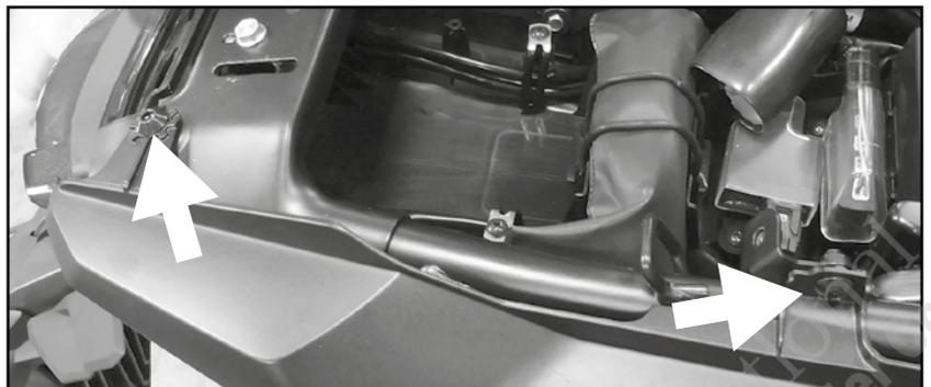
Die 2 Haltepins der Verkleidungen auf der Unterseite entfernen und die Verkleidung komplett demontieren.
