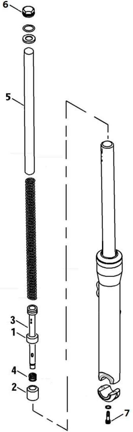
Die Verschlusschraube (6) abschrauben und die darunterliegende Vorspannhülse (5) und Feder herausnehmen.
