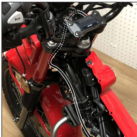
メーターコードをトップブリッジ下からバッテリー付近までメインハーネスに沿わせていきます。 Run the meter cord along the main harness from under the top bridge to near the battery.
