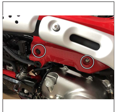
右メインパイプカバーのクランクケース上の2本のスクリューを外します。 ※カバーを少し浮かせて作業し易くします。カバーを完全に外すと作業性がさらに良くなりますが、マフラー一式を外す必要があるため、省略します。
