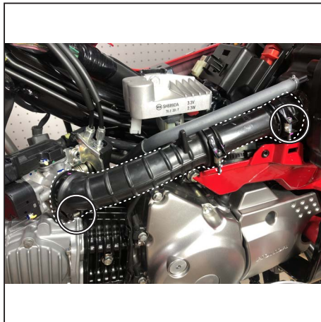
スクリュー2本を緩めて、コネクティングチューブを外します。 Loosen 2x screws and remove Connecting tube.
