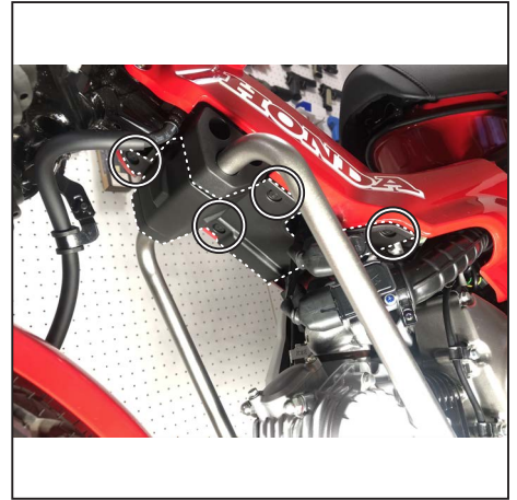
トリムクリップ（短）を4本外し、メインパイプロアカバーを外します。 Remove the 4x trim clips (short) and remove Main pipe lower cover.
