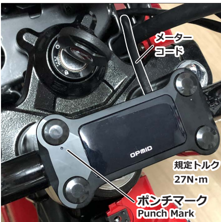
アッパーホルダーのポンチマークを前方に向け、純正ソケットボルト4本を再利用して取り付けます。ポンチマーク側のボルトから締め付けます。キーシリンダーの右側にあるブレーキスイッチコードのガイドにメーターのコードを通します。 With the punch mark facing forward, reuse the 4x genuine socket bolts to attach. Tighten the bolt on the punch mark side first.
