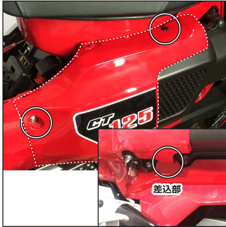
スクリュー1本とトリムクリップ（長）1本を外し、エアクリーナーガーニッシュを外します。 ※下部に差込部があります。 Remove 1x screw and 1x trim clip (long), and remove Air cleaner garnish.
