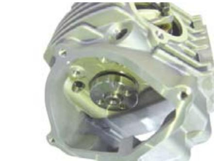
○パンスクリュー2本にネジロック剤を塗布し、SuperHead+Rキット内のカムストッパープレートを取り付けます。
