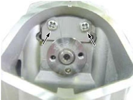
○インテーク側のロッカーアームシャフトを引き抜き、ロッカーアームをタペットホール側に少しずらし、カムシャフトを取り外します。
