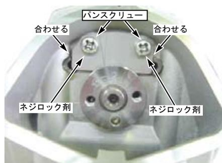
○カムチェーンをカムプロケットに取り付け、フライホイールの“T”マークをクランクケース合わせマークと合わせた時、カムプロケットの“T”マークがシリンダーヘッドの合わせマークに合う様、調整します。
