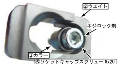
○カムプロケットの上の穴に⑤ソケットキャップスクリュー 6x20 を通し、規定トルクで締め付けます。
