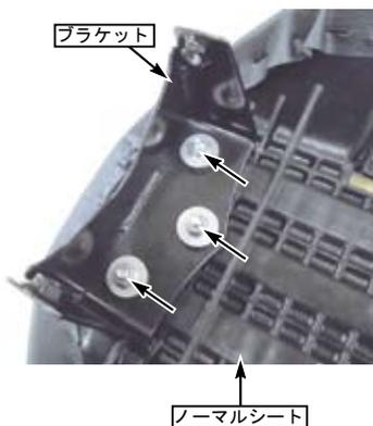
○①シート ASSY. のスタッドボルト部にノーマルのブラケットをセットし、ノーマルのフランジロックナット 6mm 3個にて取り付けます。
