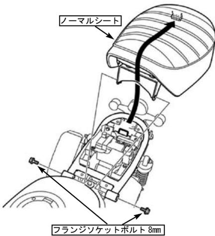
○3個のフランジロックナット 6mmを取り外し、ノーマルシートからブラケットを取り外します。
