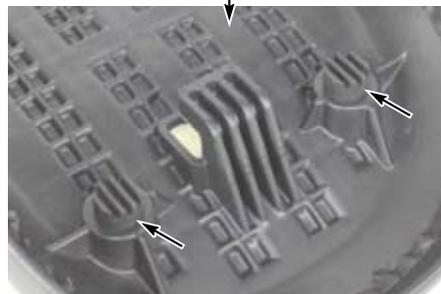
○①シート ASSY. のフックをフレームの取り付け箇所に合わせて差し込み、ブラケットとフレームの位置を合わせ、ノーマルのソケットボルト 2個にて取り付けます。
