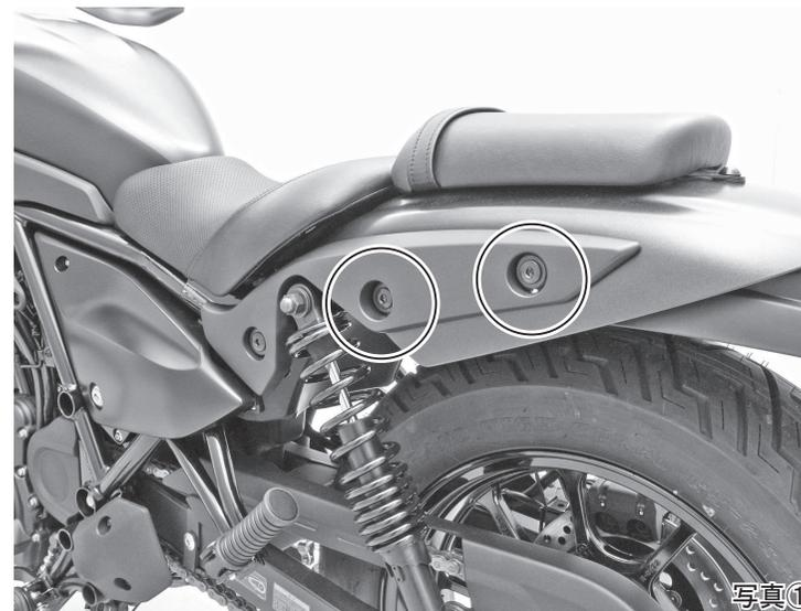
2. 前項でボルトを取り外したところに付属カラーの短い方を前側2カ所、長い方を後側2カ所にセットします。セットしたカラーの外側にバックレストステーの穴位置を合わせ、付属のM8ボルトで締め付けます。(写真②)
