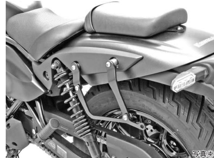
3. 前項で仮組みしたサイドバックサポートを工程1で取り外したboltの場所へ取り付け、各部の位置とクリアランスなどを調整しながら規定トルクで締め付けて完成です。
