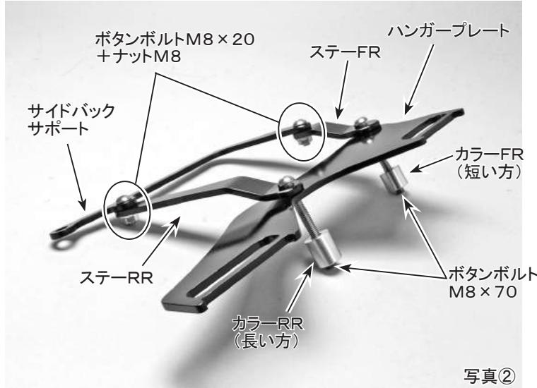
※両掛けタイプのサイドバックを使用する場合などに、ハンガープレートを取り外して使用することも可能です。
