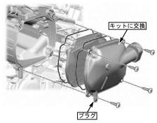
〇エアクリーナーケースカバーを取り付けます。 フィルターとエアクリーナーケースカバーの 溝が正しく嵌っているか確認してから純正の スクリューを締め付けます。
