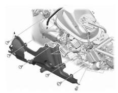
〇写真を参考に①エアクリーナーケースカバーに ②インテークダクトを取り付けます。 ※②インテークダクトの溝を、①エアクリーナー ケースカバーに合わせて下さい。
