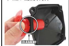
ケースカバー、パッキン、プラグを取り外し、 ①エアクリーナーケースカバー COMP と交換し、 逆手順で取り付けます。
