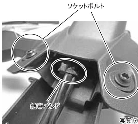
7. ソケットボルト2カ所 (写真⑤) とタッピングスクリュー2カ所 (写真⑥) を取り外し、
