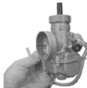
○アジャストスクリューCOMP. にSTD、D、スプリングを取り付け、キャブレターに取り付けます。
