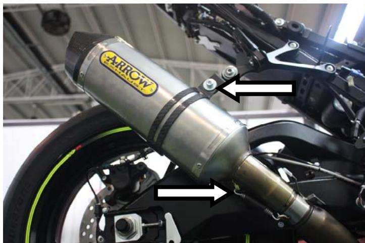
Innestare il terminale, serrarlo alla staffa mediante fascetta di sostegno ed ancorare la molla
