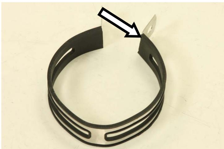
Alloggiare e tagliare a misura la guarnizione per fascetta di sostegno (se presente) – Sagomare la fascetta sul corpo silenziatore prima dell'installazione
