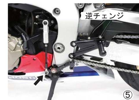
両側ピロボールはチェンジロッドに6mm以上ネジ込んでください。
