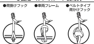
**2** 固定ベルトを車体に繋がたらパックルを本体のパックルに接続します。 前後左右平均等になるようにベルトの長さを締めて調整します。
