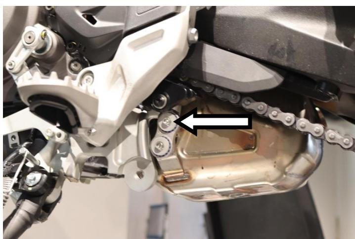
**IT** · Svitare le viti indicate (una per lato) e rimuovere il raggruppamento comprensivo di bielle di fissaggio
