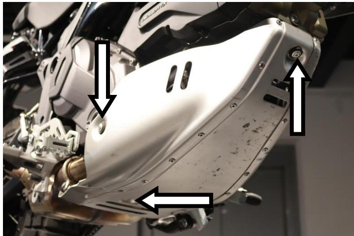
**IT** · Svitare le tre viti indicate e rimuovere il para motore
