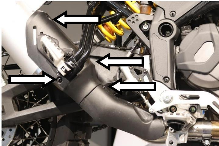
IT · Rimontare la protezione originale mediante bulloneria originale
