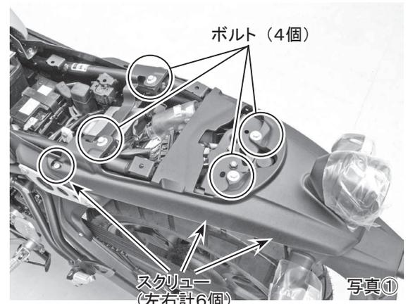
2. ウィンカー、ナンバー灯のカプラ等とナット4個を取り外し、リアフェンダーを取り外します。(写真②)
