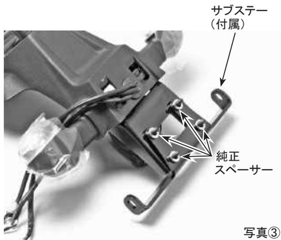
4. 前項3でサブステーをセットしたリアフェンダーを元の位置に仮止めします。(写真④)
