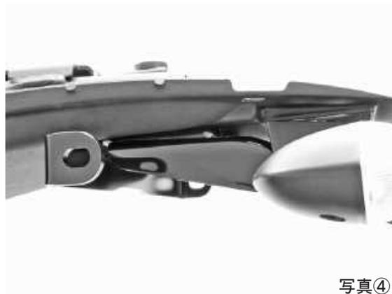
5. タンデムステップホルダーの後側のボルトだけ、左右ともに取り外します。(写真⑤)
