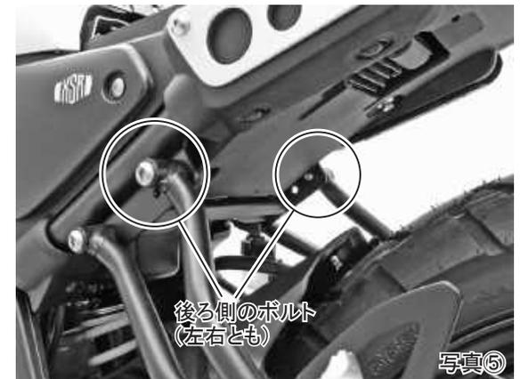
6. 前項5で取り外したボルトの箇所には、付属のボルトM8×50を使い、サブステーとキャリア本体とを付属のM8ボルト、ナットで仮止めします。全てのボルト、ナットを仮止めしたのち、各部のクリアランスを確認しながら全てのボルト、ナットを規定トルクで締め付けます。(写真⑥)
