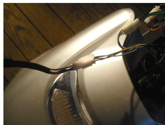
6. ソケットカバーを反時計回りに回しながら外し、バルブを交換します。ウインカーバルブも交換することができます。
