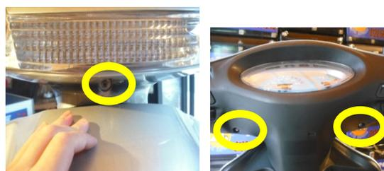
3. ミラー取り付け部付近にある爪をマイナスドライバーで写真のように外します。
