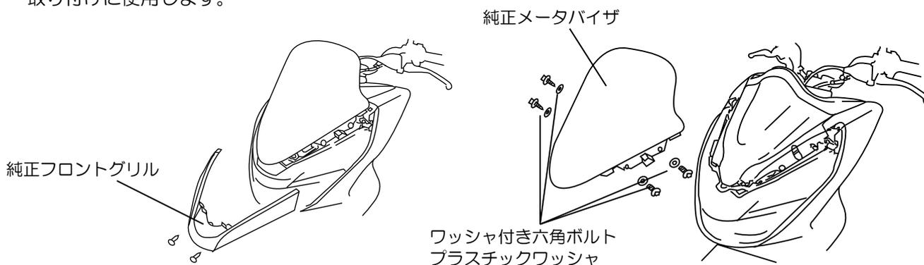
2. 純正ワッシャ付き六角ボルト、純正プラスチックワッシャを使用して、純正メータバイザが取り付けされていた位置に①GIVI スクリーンを仮組みします。
