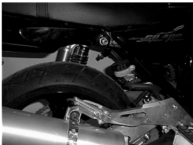
リヤサスペンション(片側)を取り外します
