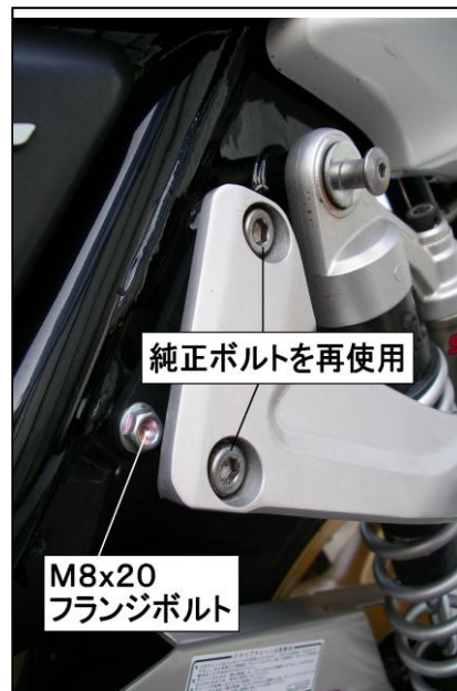
ボルトを仮付けし 隙間を空けておく
