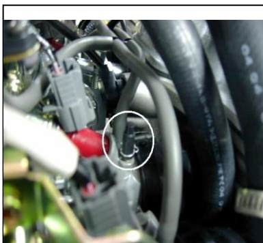
#3インテークマニホールド部バキューム取出口 に盲栓を取付けた状態
