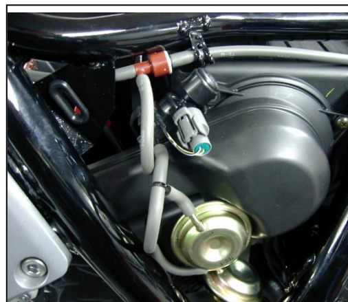
右サイドカバー内部 バキュームの配管を全て取り外します。
