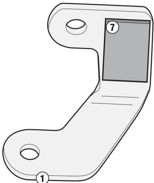
3.純正グラブバーとフレームの間に、①サポート 1(左右)と②サポート 2(左右)を③六角穴付きボルト(M8×30)と⑨純正ワッシャーを使い取り付けします。
