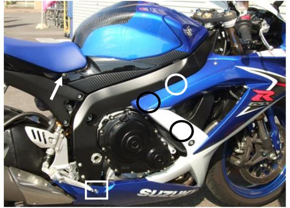
2) カウル右下後部のビス(写真① 口印)、エアダクト周辺ビス(写真② 矢印)を外し、サイドカウルを車体から引き抜き、(写真① 白○印部)浮かせます。
