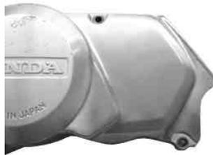
弊社プライマリースターターコンプリートエンジンの下記図と同じスプロケットカバーが装着されている車両の場合も干渉する部分を削って下さい。
