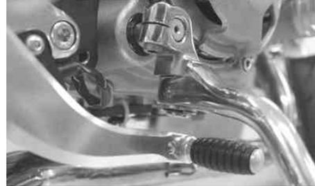
リアホイールを取り外し、ブレーキアームをキット付属の物と交換します。交換の際、ブレーキアームの合わせマーク位置を合わせず、1つ後ろ側へずらし取り付けして下さい。交換が完了すればフランジボルト6 x 2.5を取り付け締め込みます。
