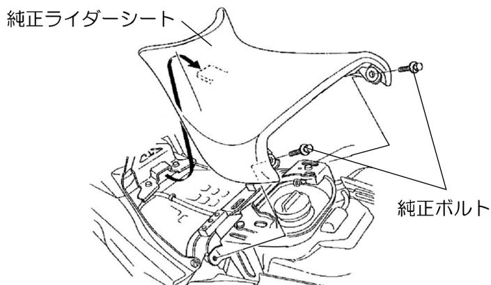
3. 純正ライダーシート裏側から、シートダンパー（2ヶ）を取り外し、①シート ASSYへ組み込みます。
