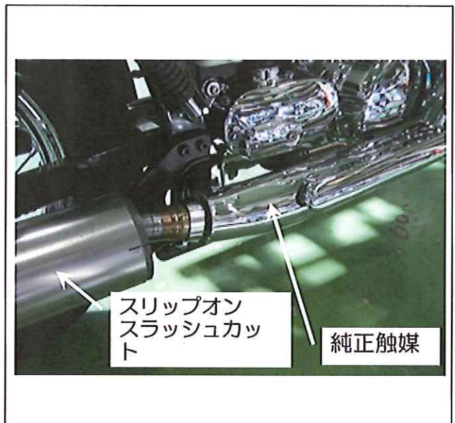
製品と純正触媒の取付写真
