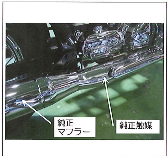
製品と純正触媒の取付写真
