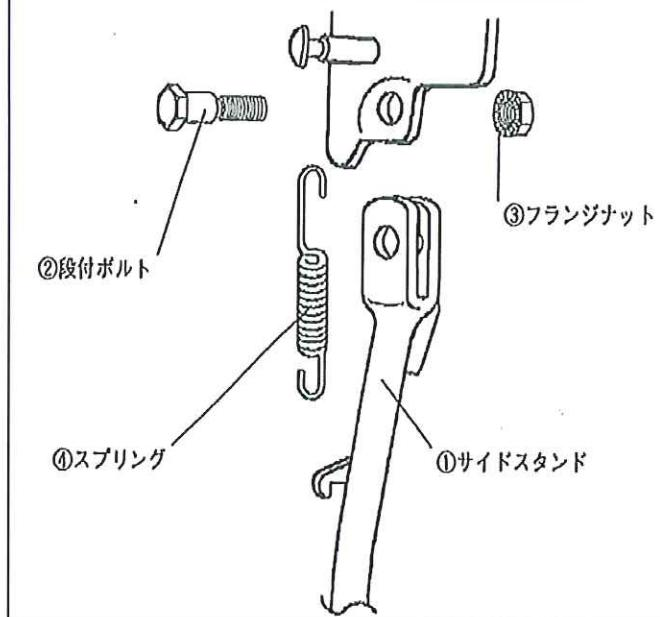
3. 裏側から③フランジナットで締め付けます。
